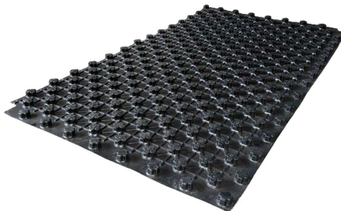
**Standard Noppenplatte** im Maß 1400 x 800 x 20 mm (ohne Dämmung) zum Befestigen des Heizrohres mit 16 - 17 mm Rohrdurchmesser mittels Druckknopf-Technik. Die Noppenplatte ist zusätzlich mit EPS-Schaumplatten in den Stärken 11 mm oder 30 mm (31 mm und 50 mm Dicke zzgl. Noppenplatte) erhältlich. Die Plattendimension ist an die Europalettengröße angepasst, was Transportkosten reduziert. Die maximale Verkehrslast beträgt je nach Unterkonstruktion 5 - 75 kPa.
